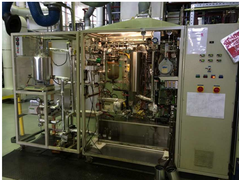
Εικόνα 7.1. Πιλοτική μονάδα υδρογονοπυρόλυσης VB01
