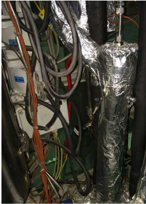
Εικόνα 7.8. Δεξαμενή στην οποία εφαρμόζουμε την ρύθμιση της στάθμης
