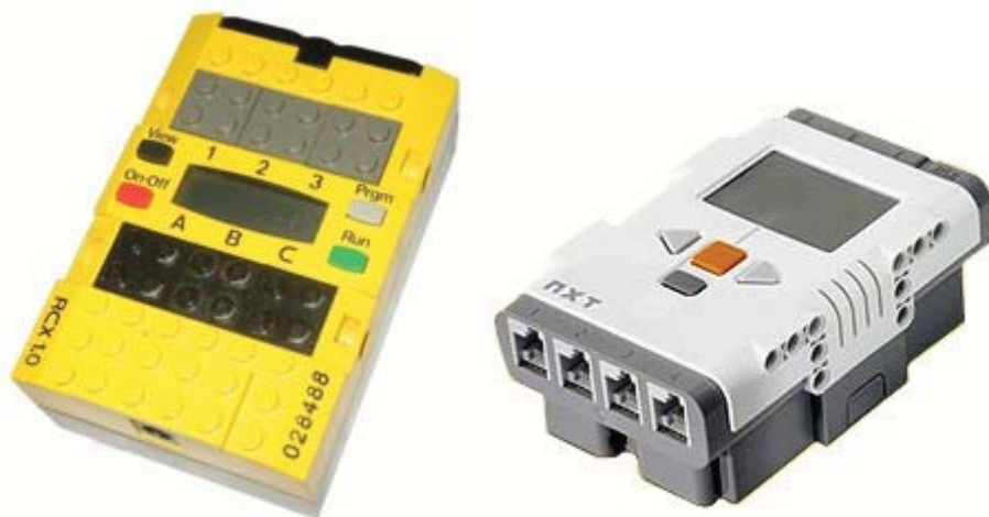
Το προγραμματιζόμενο «τούβλο» RCX της 1ης γενιάς (1998) και το πιο σύγχρονο NXT της 2ης γενιάς (2006)
